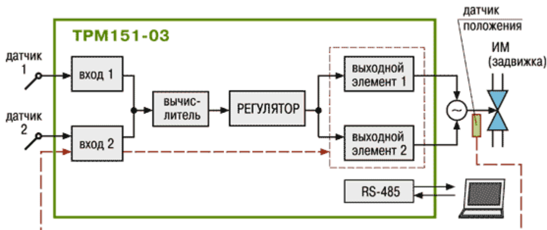
Рисунок 4.9 – Стандартная модификация TPM151 для технологических процессов
