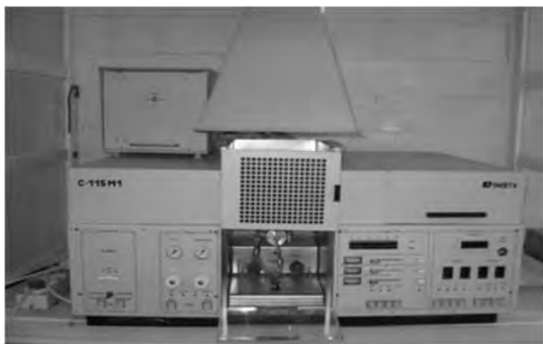
Рис. 1. Атомно абсорбционный спектрометр (ААС), С115-М1 Аквилон
