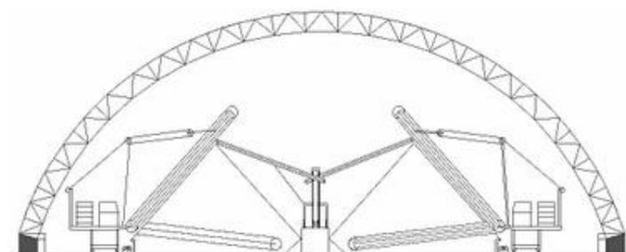
3) **Острые**: используются при больших концентрированных нагрузках, таких, например, как снег.
