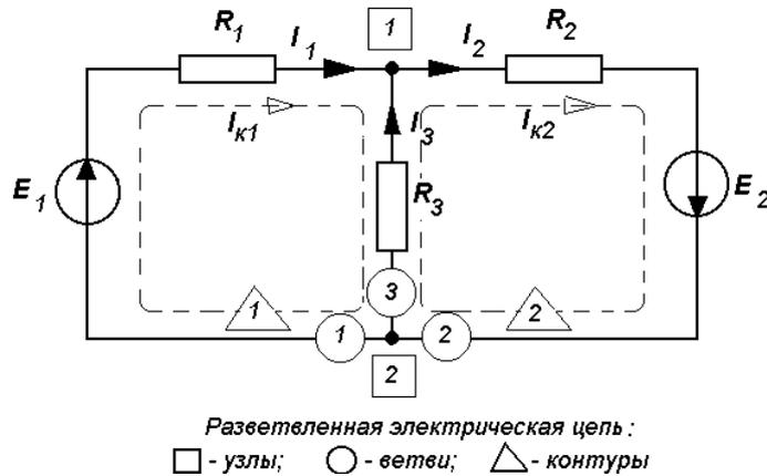
Рисунок 1.1 – Схема электрической цепи
