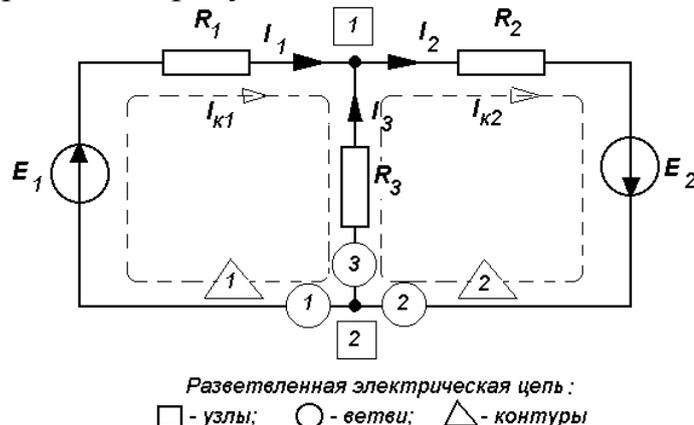
Рисунок Ш.1 – Схема электрической цепи
