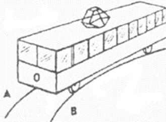
1. Рельс А. 2. Рельс В. 3. Оба рельса должны быть одинаковыми по высоте.
