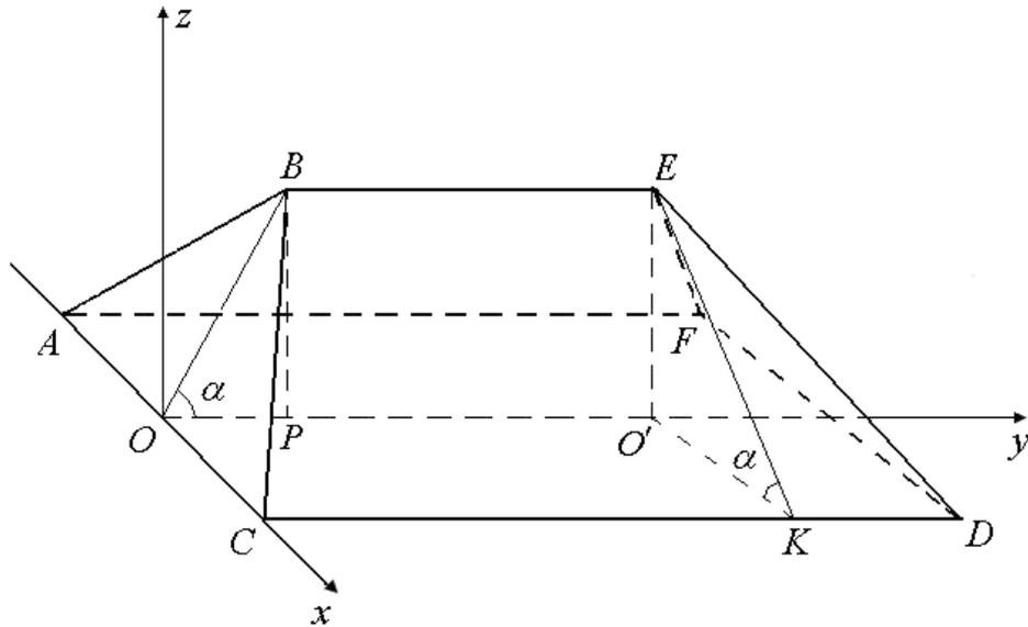
Рисунок 2.2 – Вальмовая крыша в прямоугольной системе координат
