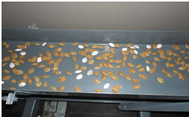
Рисунок 4.12 - Расположение плодовых косточек абрикоса при осуществлении движения по лотку вибротранспортера
