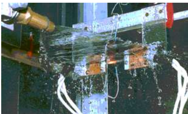
Рисунок 21. Нестационарная установка для исследования коэффициента теплоотдачи под форсунками ЗАО КОРАД.
