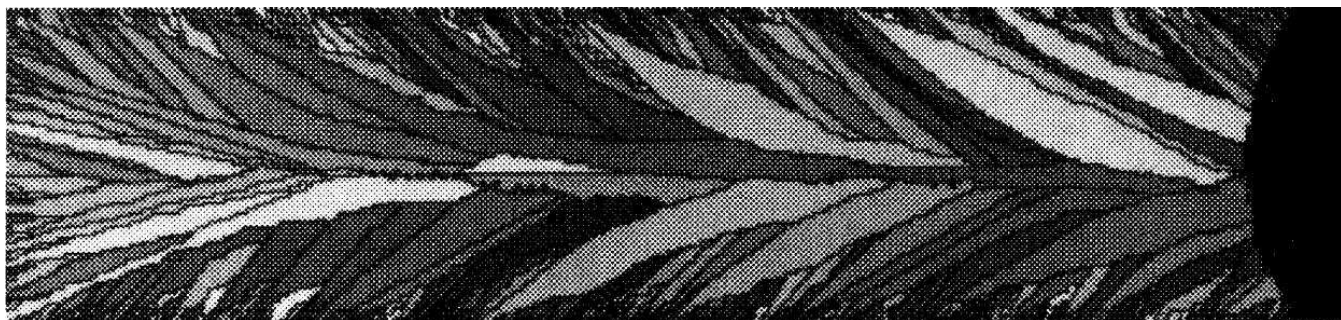
Рисунок 1. 21. Формирование монокристалла в макроструктуре непрерывного слитка [306]
