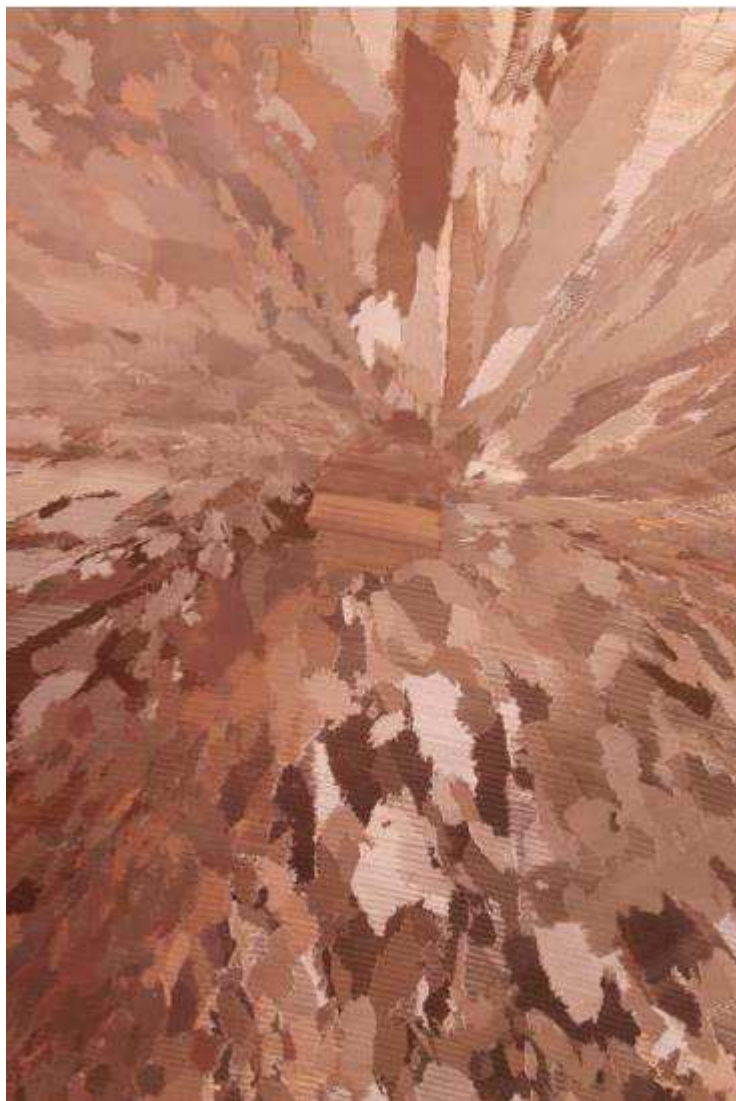
Рисунок 7.14. Поперечное сечение слитка с двумя типами структуры: столбчатые дендриты и монокристалл
