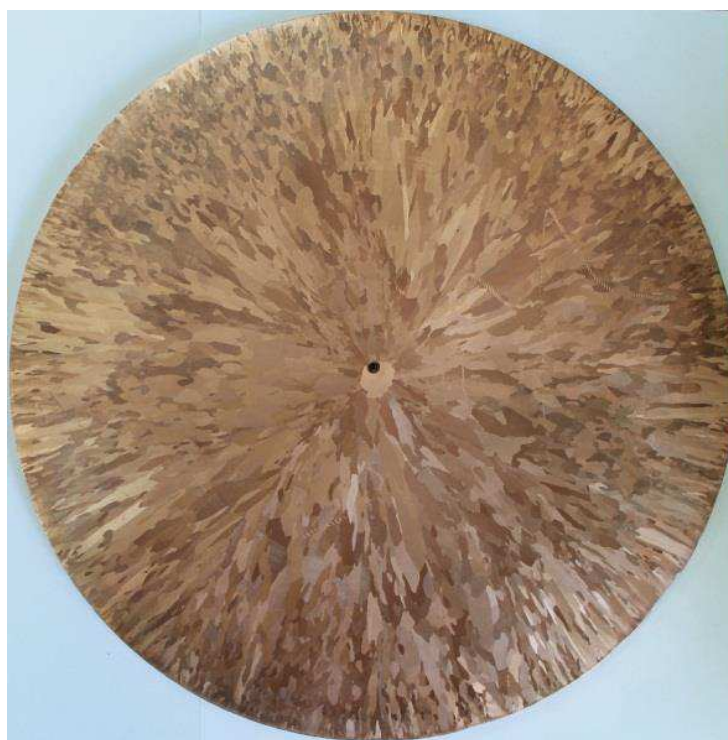
Рисунок 7.16. Поперечное сечение непрерывнолитого латунного слитка; столбчатая структура, (C), как доминирующая морфология непрерывно затвердевающего слитка; тонкая столбчатая структура (FC), расположена на периферии слитка; (E), едва заметны в центре слитка в окрестности монокристалла, который локализован в осевом направлении.
