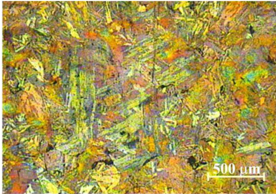
Рисунок 7.18. Сосуществование столбчатой и равноосной структуры, выявленное в стальном ковном слитке 15 тонн при его вертикальном разрезе на средней глубине.
