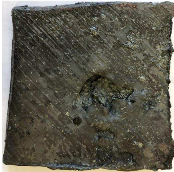
Рисунок 4.15. Темплет сортовой заготовки с жидкой сердцевиной, прошедшей в зону порезки.
