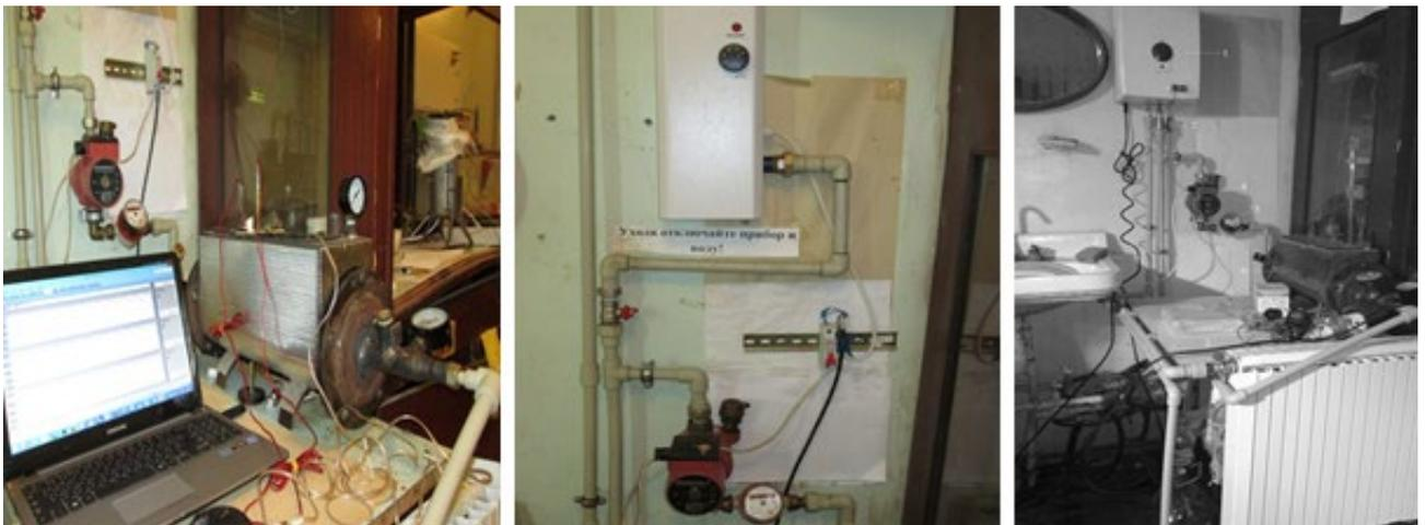
Рисунок 10 – Общий вид экспериментальной тепловой установки с ТА, включающий теплоаккумулятор, генератор теплоты, краны, циркуляционный насос, расходомер, панельный радиатор
