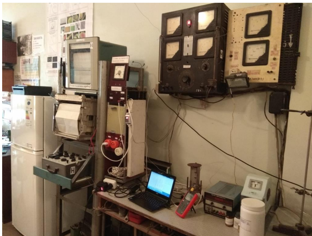
Рисунок 2.3 – Экспериментальная установка для термографирования вещества методом термического анализа
