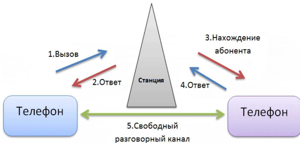
Рисунок 2.7 – Структура мобильной сети стандарта GSM
