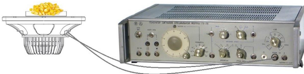
Рис. 1. Экспериментальная вибрационная установка для обработки семян вибрацией
