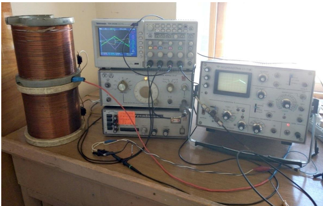
Рис. 1. Экспериментальная установка по обработке семян растений переменным магнитным полем
