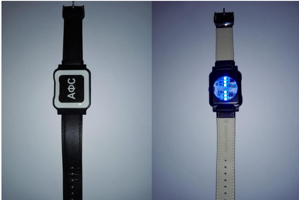
Рис. 1. Светодиодный браслет, излучающий в синем диапазоне действия 470\pm 10 нм
