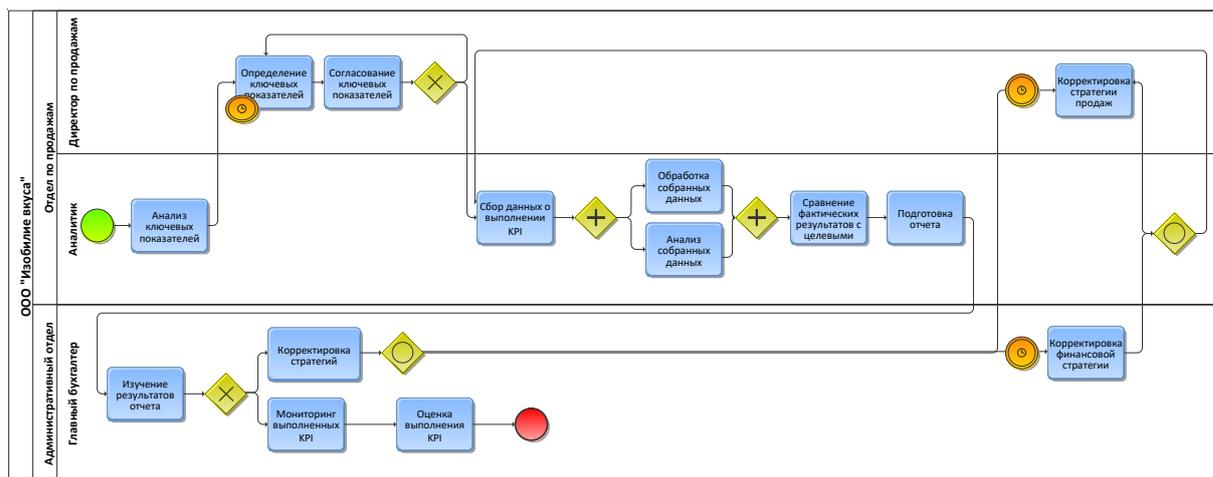
Рисунок 4 – Модель процесса «Анализ ключевых показателей (KPI)» в нотации BPMN (авторская разработка)
