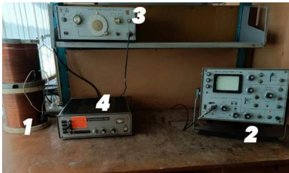
Рис. 1. Внешний вид установки по обработке семян растений переменным магнитным полем: 1 – электромагнитные катушки, 2 – осциллограф, 3 – генератор сигнала специальной формы, 4 – источник тока.
