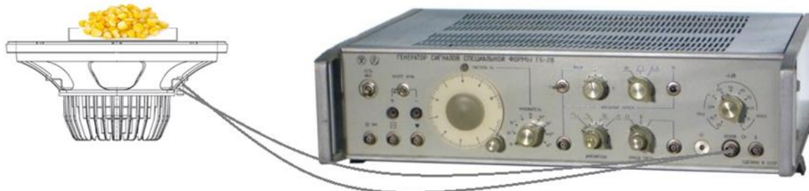
Рис. 2. Внешний вид вибрационной установки для обработки семян кукурузы сахарной
